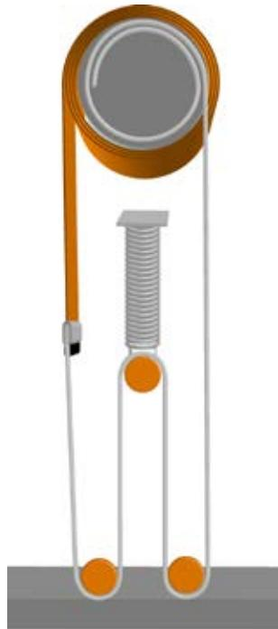
EFAFLEXOV sistem zaštite od vетара, obezbeđuje permanentno napetost vratne ploče. Idealan svuda gde vетар i podtlak prouzrukuju promaju.
